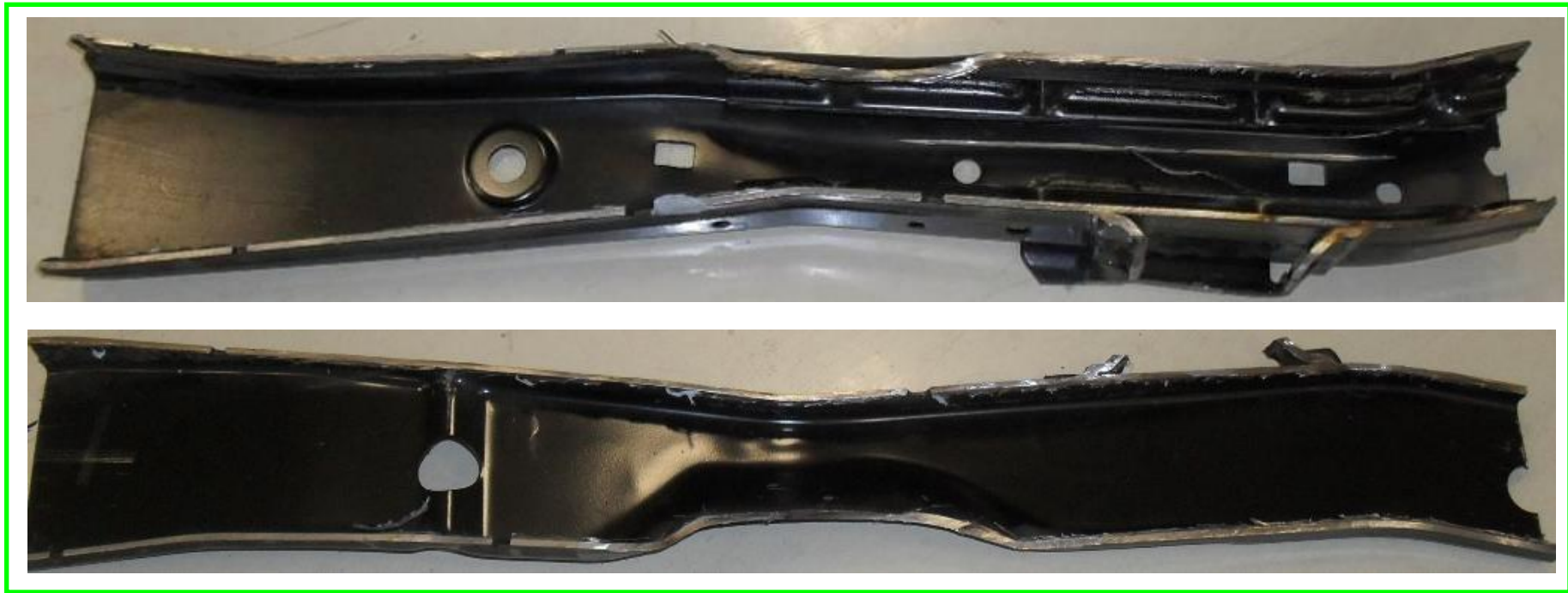
Engine cradle wymalowany na lini KTL w Kirchhoff Polska (po 336 h próby w komorze solnej)
